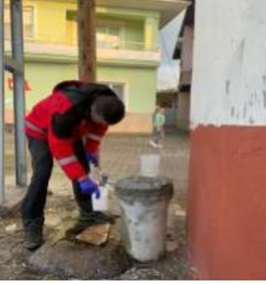
Şekil 5.12: Göçbeyli Köyü Yeraltı Suyu Numune Alma Çalışması
