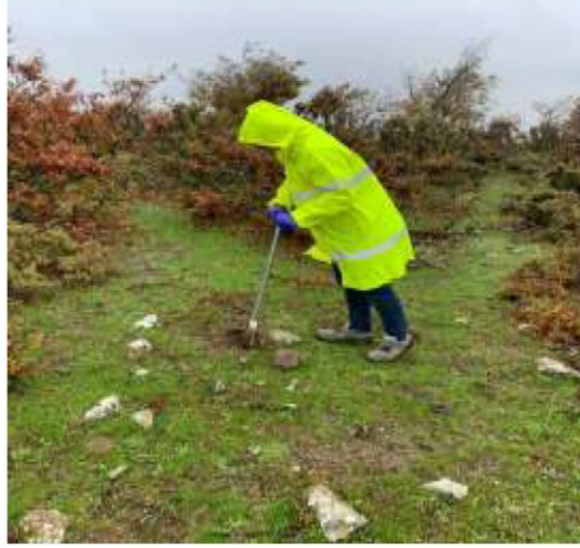
Şekil 6.6: Şalt Sahası-2'de Toprakтан Numune Alma
